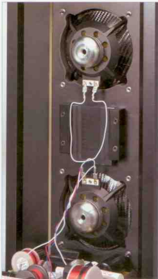
Nulllinie: Zwei Kanusmitteltöner nehmen einen AMT-Hochtöner, made by Mundorf, in die akustische Zange – voilà, d'Appollo ...
