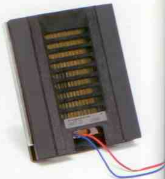
Made in Germany, wo denn sonst? Mitteltöner mit Kevlar-Membran und belüfteter Schwingspule (links). Den berühmten Air Motion Transformer (AMT) von Oskar Heil gibt es in verschiedenen Größen; hier eine mittlere Ausführung (rechts)
