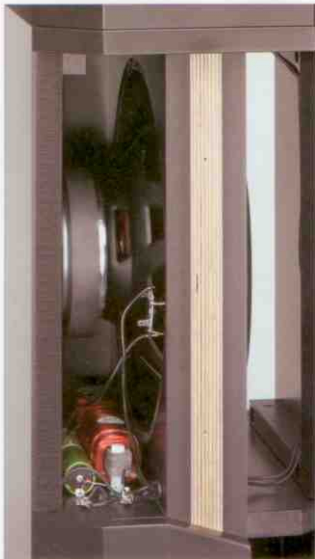
Zentralmassiv: Ein extrastarkes MPX-Sandwich fixiert die gegenphasigen Tieftöner, die in jeweils zwei Kammern hineinstrahlen
