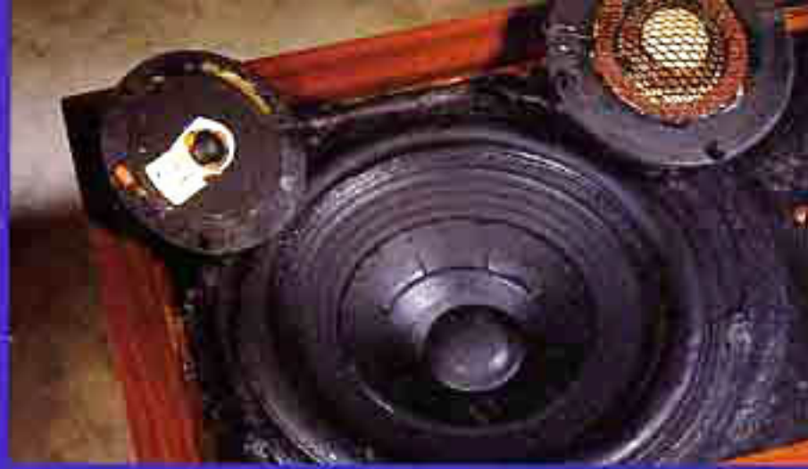
Hermetisch geschlossenes Gehäuse, massive Chassiskörbe und kraftvolle Magnete, die Chassis dick mit Dichtmasse in ihren Aussparungen verklebt. So präsentiert sich das Lautsprecherprinzip mit US-Patent 2,775,309.
