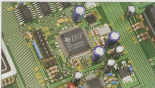
So kann ein UKW-Stereodecoder auch aussehen: Accuphase perfektioniert den analogen Radioempfang auf digitalem Weg – hier der Signalprozessor (DSP) von Texas Instruments.
