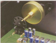
Hochmoderne Abstimmtechnik, klassisches Drehgefühl: Dreh-Inkrementgeber mit präziser Schwungmasse im Accuphase T-1000.
