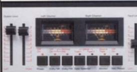
Große frequenzkorrigierte Spitzenwert-Anzeigeelemente, Eingangs- und Ausgangspegel kanalgetrennt über sauber laufende Flachbahnregler. Tastenaktivierung wird durch LEDs angezeigt.
