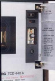
Unter einer Klappe gut zugänglich ist die Azimut-Korrektur des Aufnahmekopfes. Darüber der Schalter für den Testton-Generator.
