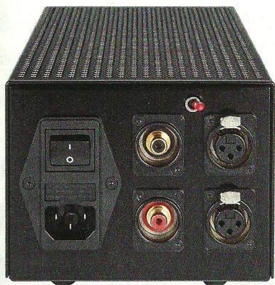
▲ Der Kippschalter oben steuert ein Relais, das zwischen den Cinch- und den XLR-Eingängen umschaltet.
