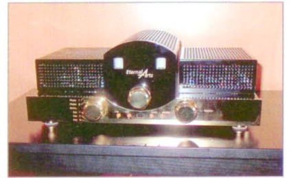
Der Eternal-Arts-Vollröhren-Vorverstärker FTP besitzt Moving-Coil-Eingänge mit und ohne Übertrager
