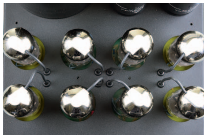
Nur für Servicepersonal: Kleine Bohrungen im Chassis schaffen Zugang zu den Potis, mit denen auf geringstmögliche Gleichspannung am Ausgang abgeglichen wird. Ansonsten bleibt die Haube zu.
